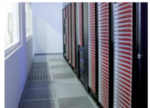
Seit September ist am ITWM »Hercules« zuständig für aufwändige Simulationen und Visualisierungen: Er besteht aus 272 Standard-Servern, rechnet mit 8,1 TFLOPS und ist damit einer der schnellsten Supercomputer Deutschlands. Weltweit gehört er zu den energieeffizientesten und mit innovativen Kühlkonzepten im Serverraum wird zusätzlich Strom gespart.
