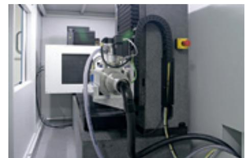
Der Computertomograf am ITWM: Gesamtansicht und Blick ins Innere; im Vordergrund ist die Röntgenröhre zu sehen, im Hintergrund der Detektor
