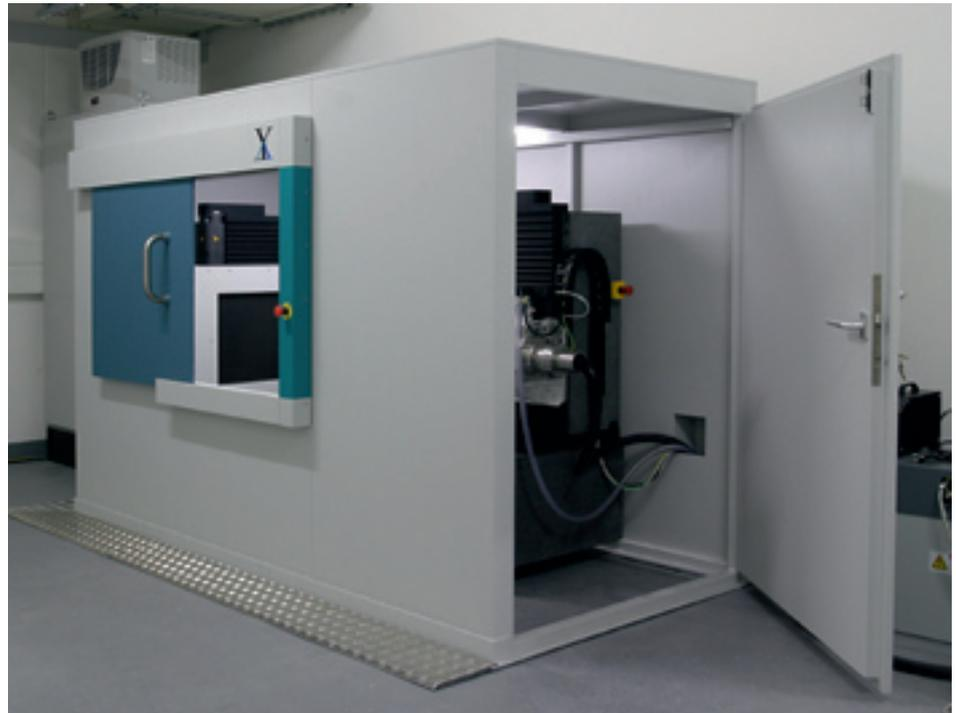
Richtungen über das Objekt zu gewinnen. Danach durchlaufen die so erhaltenen Daten einen speziellen Algorithmus, mit dessen Hilfe eine Rekonstruktion der Verteilung der Röntgenstrahlungsabschwächung in den jeweiligen Radiogrammen möglich ist. Der nächste Schritt besteht darin, zweidimensionale Bilder zu erstellen. Diese werden Schnittbilder genannt, weil sie genau das zeigen, was sich in der jeweiligen Scan-Ebene befindet, wenn man das Objekt schneidet.
