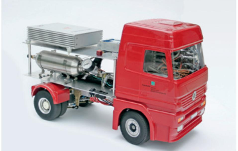
Modell-LKW im Maßstab 1:10 mit CAN-Bus und Luftfederung
