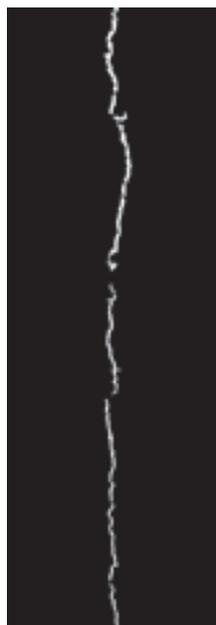
Riss in einer Betonbrücke, Analyse der Aufnahme (rechts)
